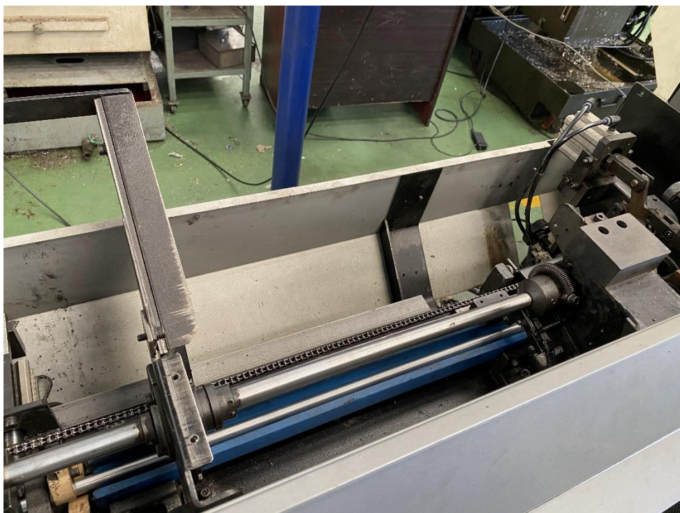
ภาพ ข-3 ตรวจสอบมอเตอร์เกียร์และระบบรางเลื่อน
