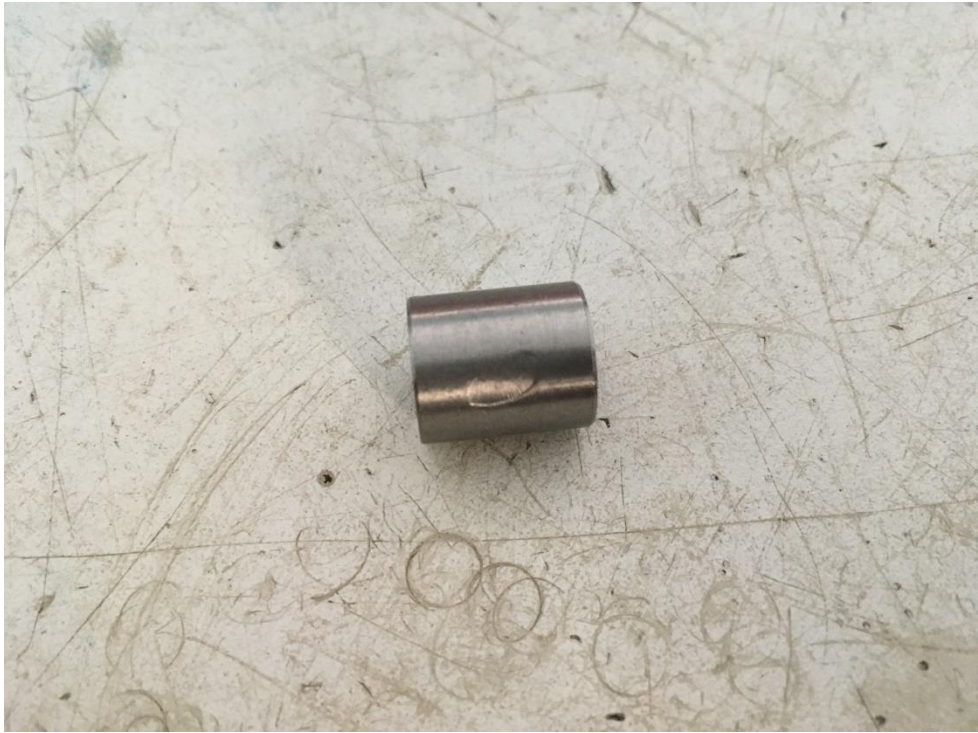
ภาพ ก-5 ลักษณะของเสียบที่ผิวด้านข้างมีรอยตำหนิ
